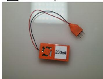
Zum Laden des Akku's den „Ein/Aus Schalter“ ausschalten und den 3-Poligen Ladestecker in den 3-Poligen Teil der „Lade/ Updatebuchse“ einstecken und anschliessend die Ladeplatine mit einem 5V USB-C Netzteil über die USB Buchse verbinden. Der LED Status „ROT“ Ladevorgang, LED Status „GRÜN oder BLAU“ Fahrzeug fertig geladen.
